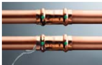
Na górze: szczelność po zaprasowaniu. Na dole: widoczne niezaprasowanie.
